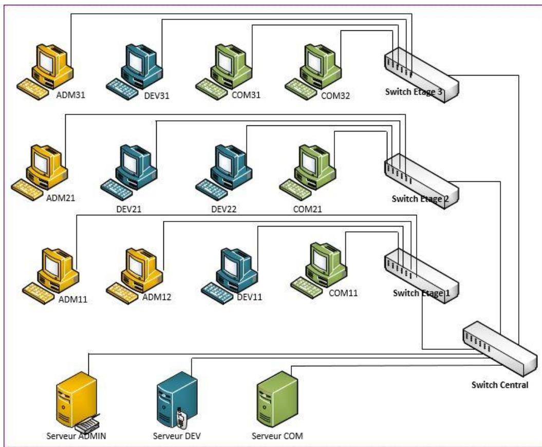
À chaque étage, un local technique concentre les connexions de l'étage : par simplification ce local technique ne comportera dans la maquette qu'un seul switch cisco 2960 doté de 24 ports. Les serveurs sont situés au rez-de-chaussée et sont connectés directement au Switch Principal ou Switch Central, situé dans le local technique du rez-de-chaussée.
