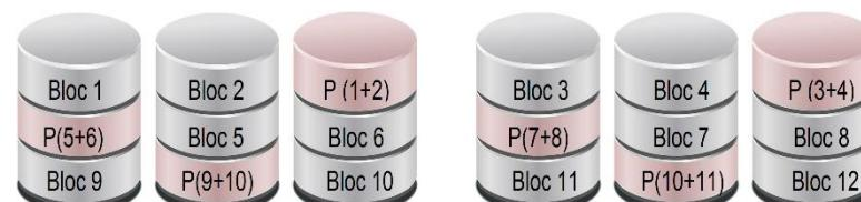
Combinaison d'un RAID 5 et d'un RAID 0
