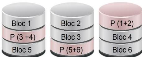
Il utilise le principe de parité avec des données écrites de façon entrelacée comme en RAID 0. Pour un ensemble de x disques, on ajoute un seul disque. Son N<sup>ième</sup> bit sera le bit de parité formé à partir de chacun des N<sup>ième</sup> bits de l'ensemble des x autres disques. Si un disque tombe en panne, il peut être reconstitué à partir des x-1 autres disques. Pour chaque écriture, les blocs de parité sont donc remis à jour.
