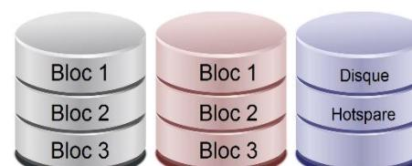
Le disque Hot Spare ou disque de rechange n'est pas utilisé sauf dans le cas d'une panne sur l'un des disques du RAID (ci-dessus un exemple en RAID 1).
